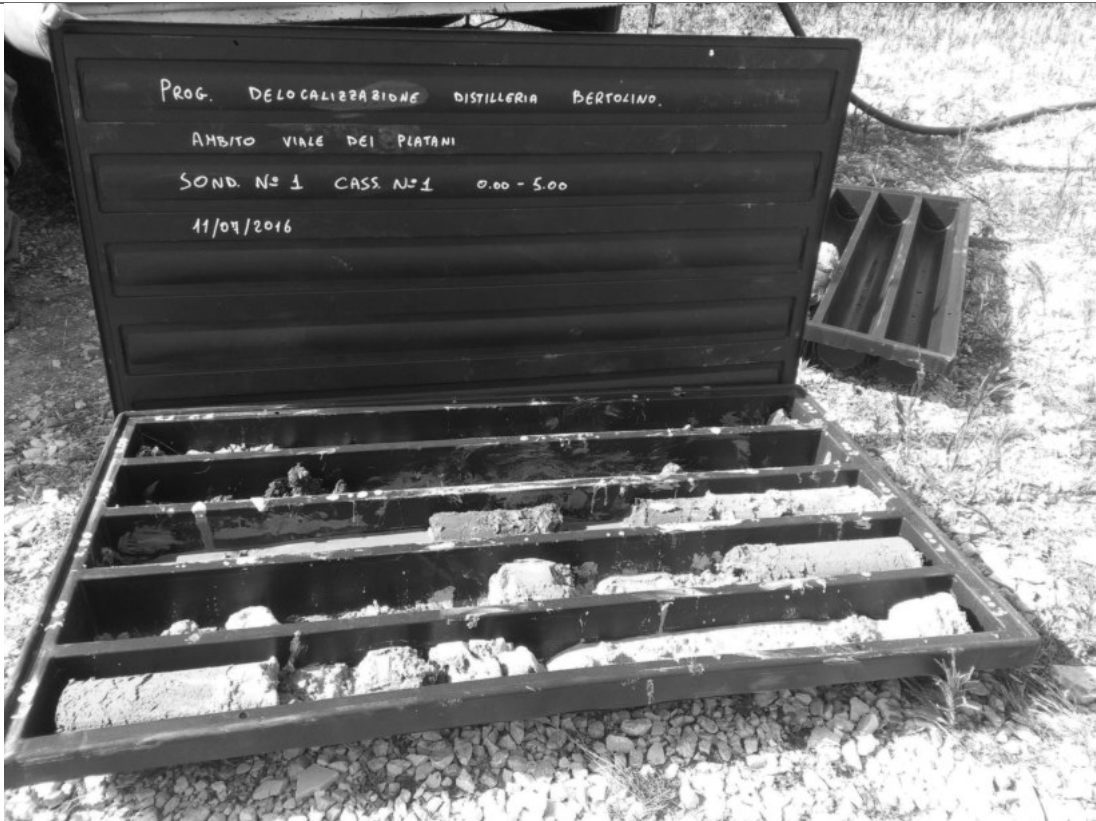
Cassetta Catalogatrice n.1 Sondaggio S.1 da 0,00 a – 5,00 m – Campione prelevato S1C1 da 1,00 m a – 1,90 m
