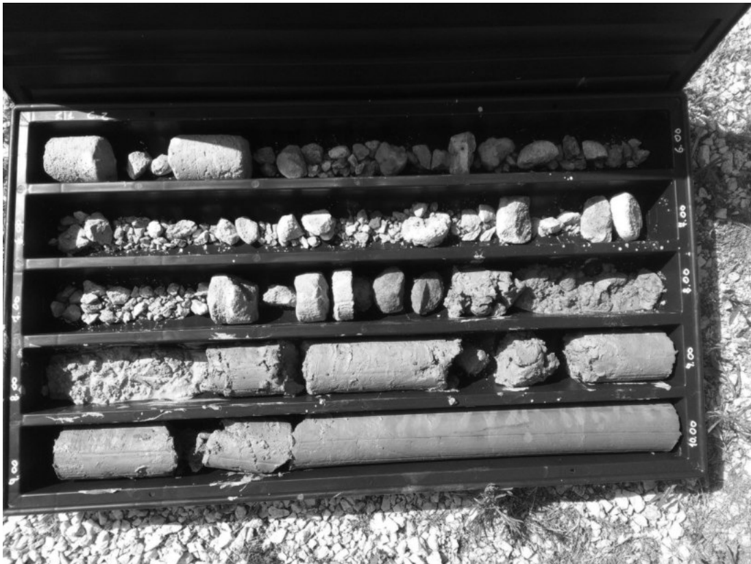
Cassetta Catalogatrice n.2 Sondaggio S.1 da 5,00 a – 10,0 m – Prova SPT da 9,00 – 9,45 m
