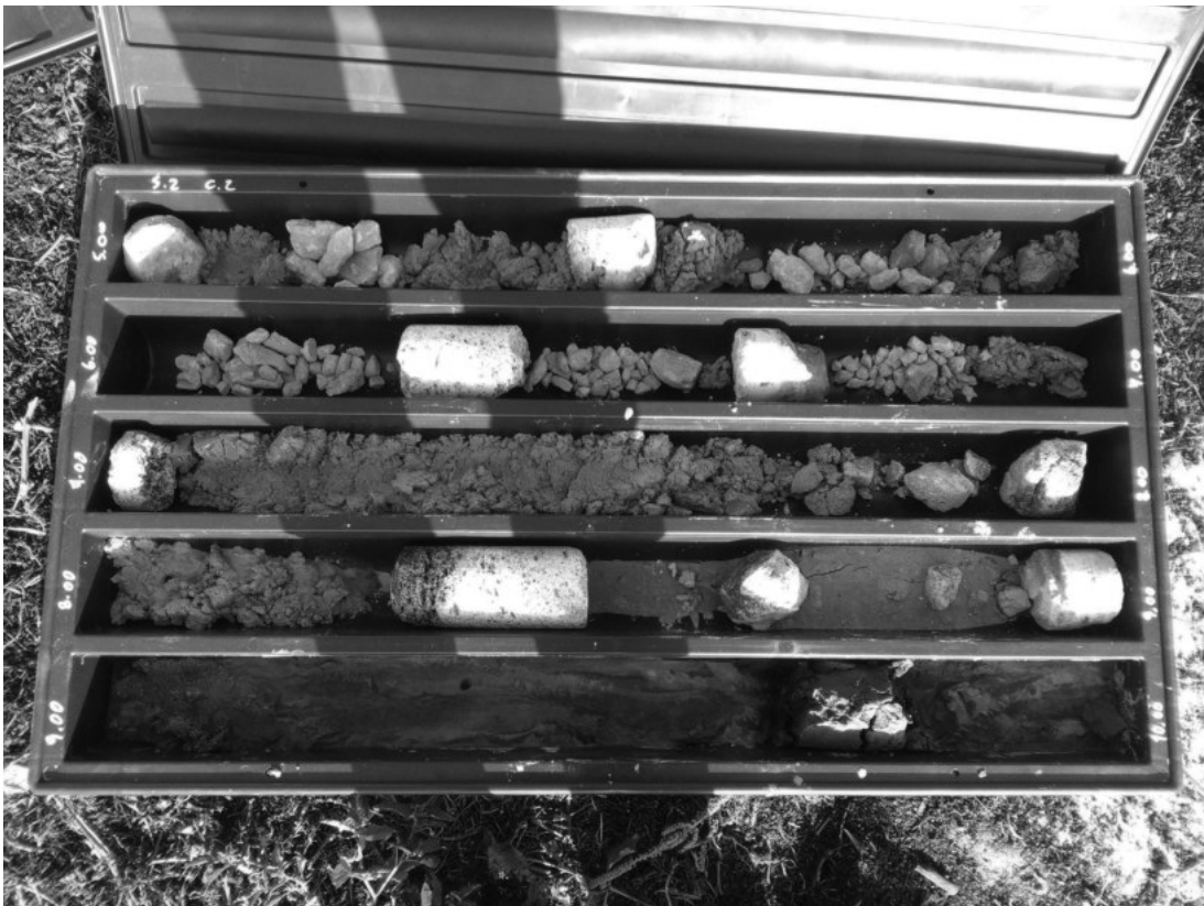
Cassetta Catalogatrice n.2 Sondaggio S.2 da 5,00 a – 10,0 m – Prova dinamica SPT in foro da – 4,70 m
