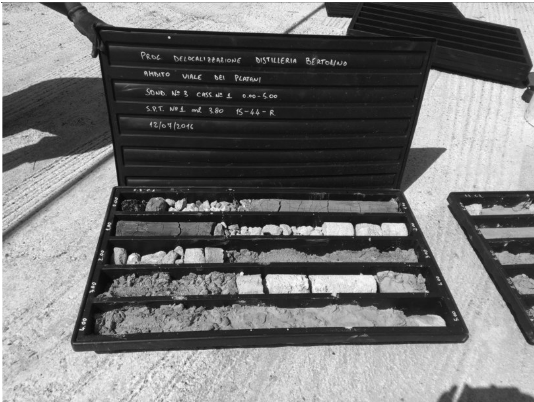
Cassetta Catalogatrice n.1 Sondaggio S.3 da 0,00 a – 5,00 m - Prova SPT da 3,80 a 4,15 m
