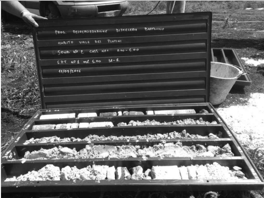
Cassetta Catalogatrice n.1 Sondaggio S.2 da 0,00 a – 5,00 m – Prova dinamica SPT in foro da – 1,90 m
